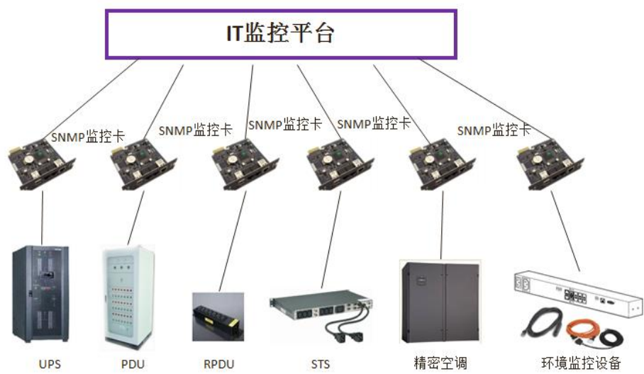
图表 2-1 通过设备智能监控卡采集监控数据
