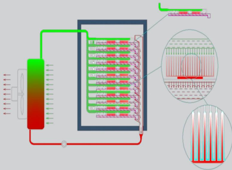
低温冷却液进入服务器直接精准喷淋芯片及主板上的发热单元，吸收热量，吸热后的高温冷却液进入液冷冷却系统换热重新成为低温冷却液，再次进入服务器进行喷淋，冷却液全程无相变，如此单相循环。
